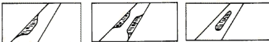
FIGUR 5.5.6.4-2 Enkelsidig avsmalning, dubbelsidig avsmalning och bred mittrefug. Sidoförskjutning med avsmalning kan utformas t ex som trianglar med avrundade hörn, inbördes förskjutna i längsled, se figur 5.5.6.4-3.
