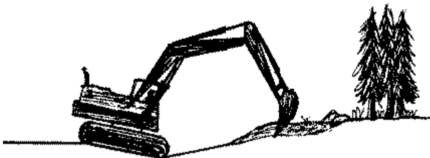
FIGUR 5.8.8.5-3 Utläggning av massor med grävmaskin för att undvika packning av materialet.
