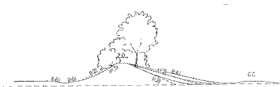
FIGUR 5.8.7.4.1-2 Mjuk, konkav släntutformning med varierande lutning.
