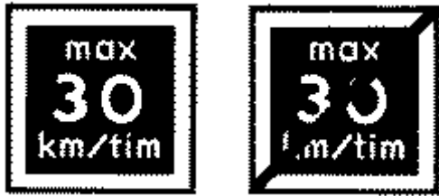
FIGUR 5.5.6.5-1 Utmärkning av område eller sträcka där farthinder anlagts.
